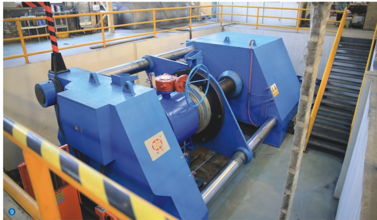
6 渗透检测 7 磁粉探伤 8 超声检测 9 大型压力检测机
